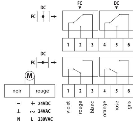
DC : Contact position ouverte du clapet
