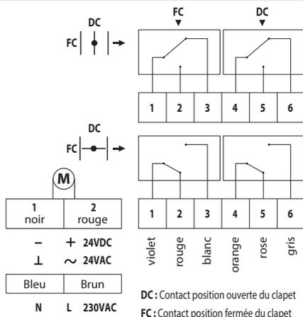
DC : Contact position ouverte du clapet
