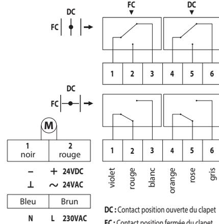
DC : Contact position ouverte du clapet
